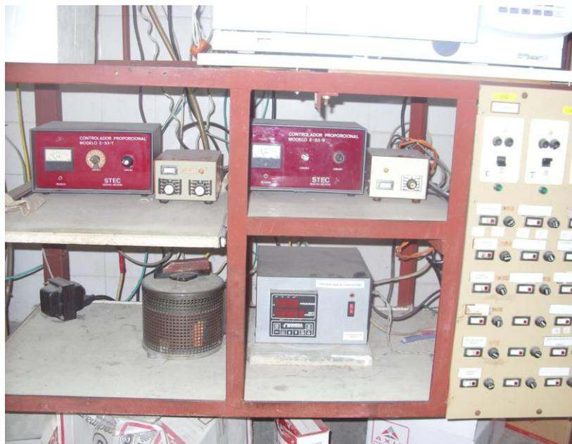
**Figura IV. 7:** Controladores de temperatura empleados en la regulación de temperatura del sistema catalítico
