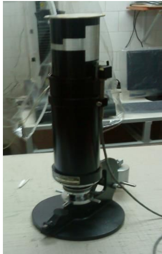
Figura II.13. Equipo Gurley utilizado para medición de porosidad de papeles.
