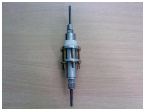
Figura II.11. Imagen del reactor de acero inoxidable utilizado.
