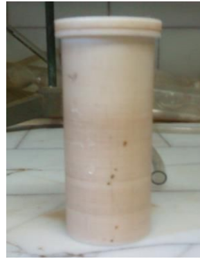
Figura II.3. Recipiente con cuerpo y tapa de teflón de 100 cm 3 .
