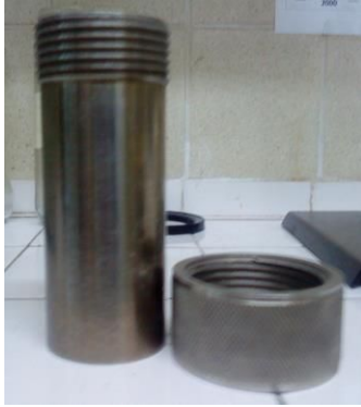
Figura II.2. Autoclave de acero inoxidable AISI 304 del tipo reactor Parr.
