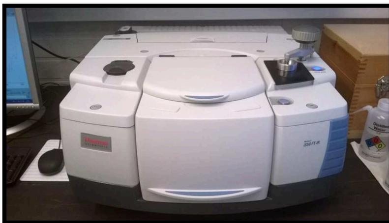
**Figura 3.16** Espectrómetro Nicolet FTIR IS50.
