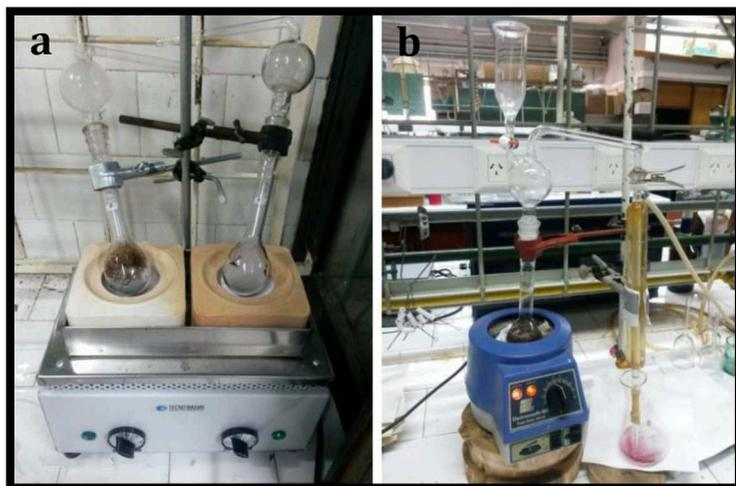
**Figura 3.12** (a) Equipo de digestión y (b) equipo de destilación para la determinación de nitrógeno por el método Kjeldahl.
