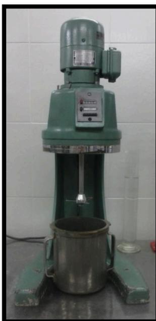
**Figura 3.1** Desintegrador estándar British de baja consistencia.
