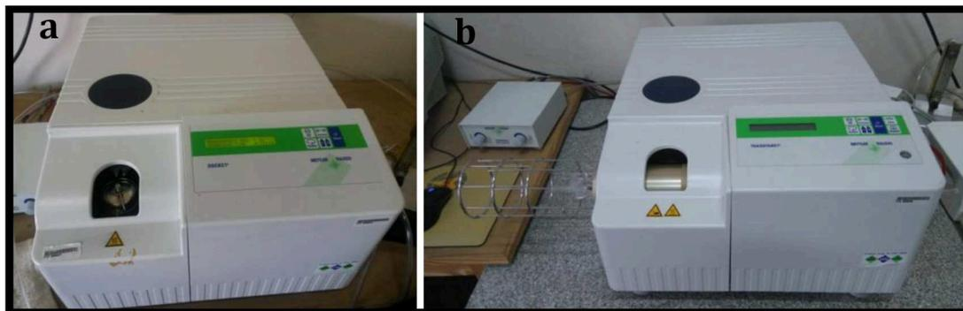
**Figura 3.18** Calorímetros Mettler: (a) módulo DSC821<sup>e</sup> y (b) módulo TGA/SDTA851<sup>e</sup>.
