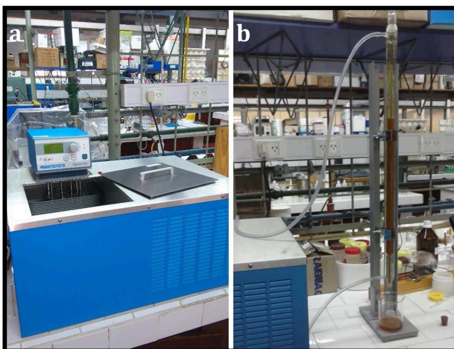
**Figura 3.20** (a) Criotermostato Cole-Parmer y (b) viscosímetro capilar gravitatorio.
