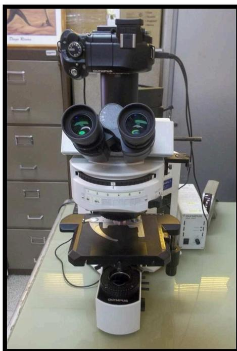
**Figura 3.19** Microscopio óptico Olympus BX51.
