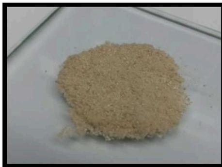
**Figura 3.11** Carbamato de celulosa preparado en el laboratorio.
