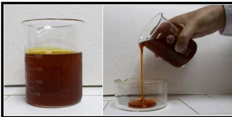
**Figura 3.14** Solución de viscosa preparada en el laboratorio.
