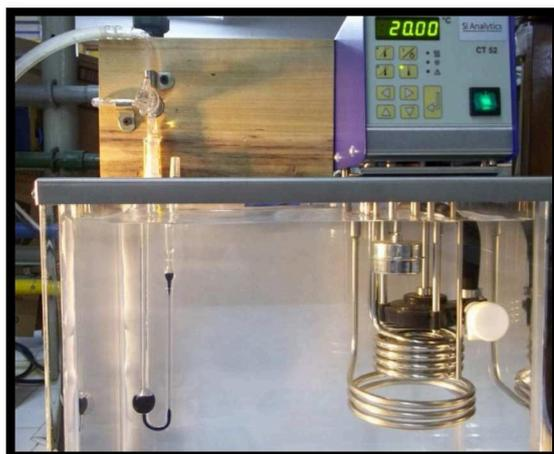
**Figura 3.6** Baño termostático Schott CT52 y viscosímetro capilar de vidrio IVA.
