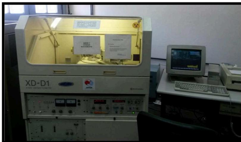
**Figura 3.17** Difractómetro de rayos X Shimadzu XD-D1.
