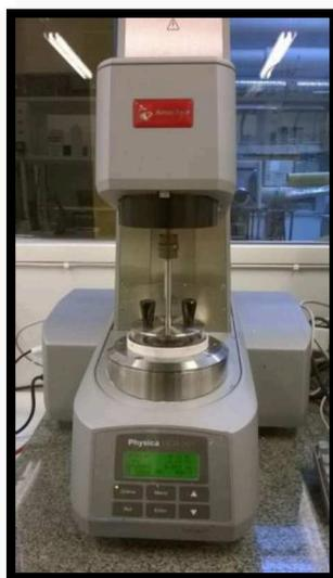
**Figura 3.21** Reómetro Anton Paar Physica MCR 301.
