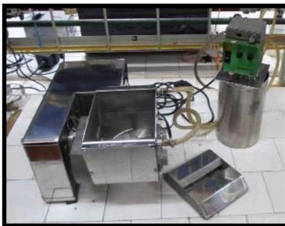
**Figura 3.3** Vista general del reactor *batch* de acero inoxidable y del cabezal termostático Braun Thermomix 1420.
