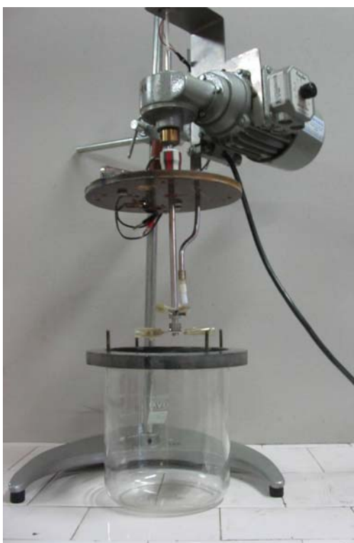
Figura 6.18. Reactor de 3 L utilizado para llevar a cabo el tratamiento con ozono.
