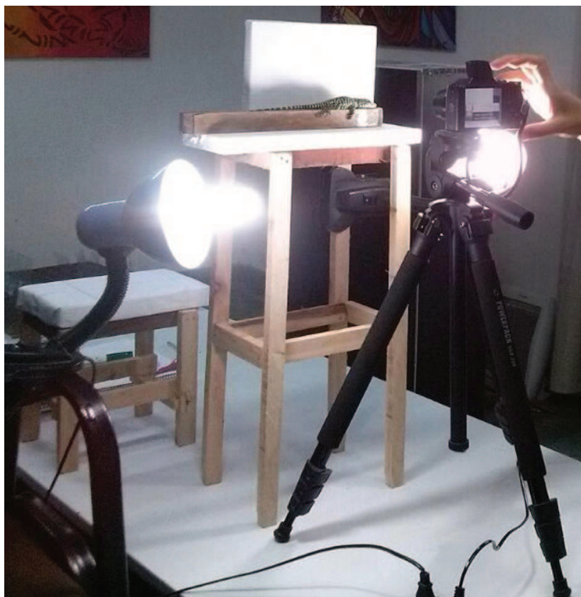
Figura 31. Montaje para la captura fotográfica de un individuo en su perfil derecho. Se observan los elementos utilizados para obtener fotografías adecuadas: cámara fotográfica de alta resolución, plataformas fabricadas especialmente para dichas capturas, trípode y lámparas para generar luz adicional.
