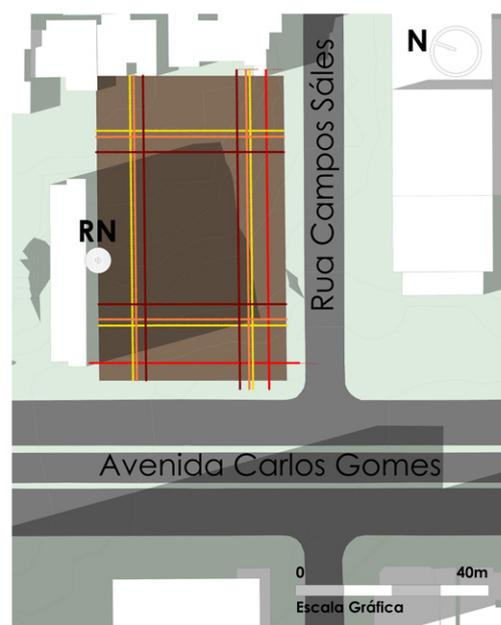
**FIGURA 3** | Estudo solar em solstício de inverno durante horário crítico e definição de recuos. Fonte: Acervo do projeto de pesquisa em desenvolvimento intitulado «Investigação sobre o Processo de Projeto Performativo: as Edificações Bioclimáticas e Energeticamente Eficientes», 2023.
