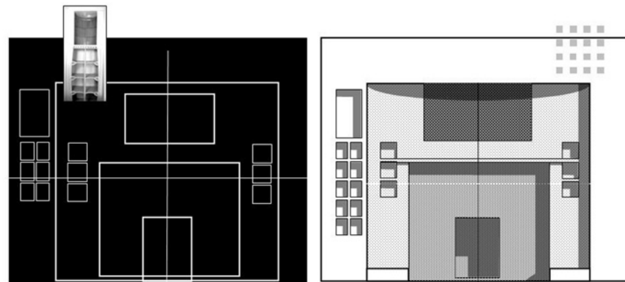
FIGURA 5d | Vista frontal del Fireplace del Salón principal de la Hill House en que se aprecian los diferentes huecos engastados en el cuerpo de la pieza, utilizados para depositar objetos y libros. Fuente: dibujo del autor a partir de fotos propias tomadas en agosto de 2023.
