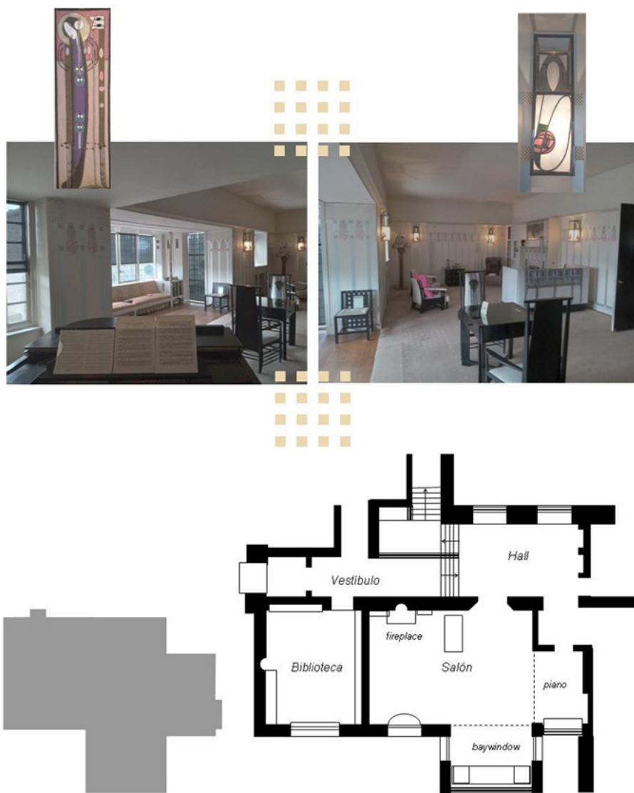
FIGURA 5a y 5b | Fotos y planta del Salón principal de la Hill House en la que se advierte la irregularidad de su perímetro que alberga la sala del piano (hacia el este) y el bay window (hacia el Sur) como alcoves conectadas al espacio del Salón ( Hall ). Fuente: dibujo a partir de fotos propias tomadas en agosto de 2023.
