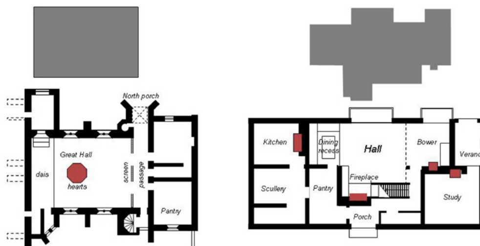
FIGURA 4a y 4b | Plantas del Hall de Penshurst Place y de Crossways. Se observa la evolución y transformación del Hall que pasa de ser un único ámbito a subdividirse en varios ámbitos segregados del cuerpo central. También el fuego pasa de la ubicación central ( Hearth ) en Penshurst a localizaciones perimetrales y específicas como el fireplace y el inglenook dispuestas en cada uno de los ámbitos segregados del Hall. Fuente: dibujos del autor a partir de la información consultada: Figura 4a: https://in.pinterest.com/pin/395824254757616213/ y Figura 4b: planta del proyecto Crossways realizada a partir de dibujos perspectivos de M. H. Billie Scott. https://www.ebay.com/itm/176064384903
