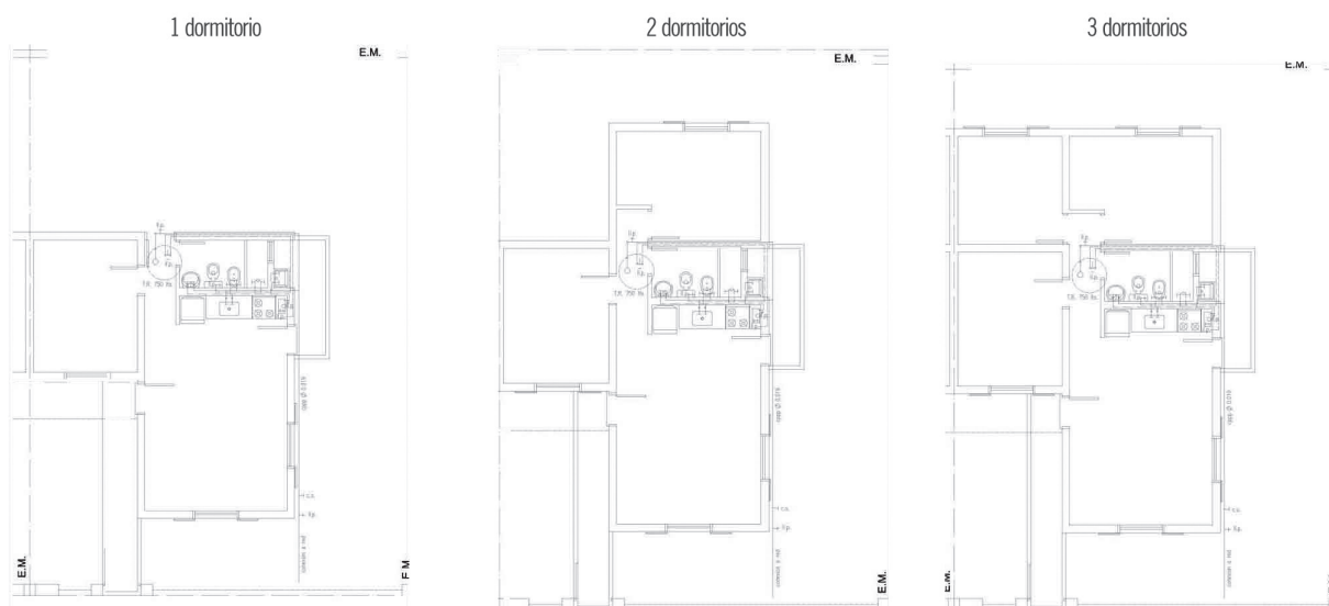
FIGURA N°1 | PROTOTIPOS DE LAS UNIDADES HABITACIONALES, PROGRAMA IX-DIGNIDAD. Evaluación del hacinamiento por superficie, falta de funcionalidad y de ventilación e iluminación adecuadas, viviendas en barrios Las Heras y Don Emilio. Fuente: Departamento de Arquitectura de la Municipalidad de Gral. Pueyrredón.
