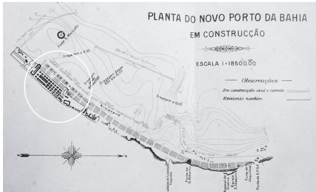
FIGURA 1 | *Planta do Novo Porto da Bahia em construção* (Mensagem..., 1915). Em preto, vê-se o perfil preexistente da Cidade Baixa e, em vermelho, as áreas a serem aterradas para a construção do porto moderno. Na primeira fase das obras do porto, na década de 1910, foi construída apenas a parte assinalada com o círculo amarelo, e o Quebra-mar Sul. Trata-se do trecho correspondente ao coração do bairro do Comércio.
