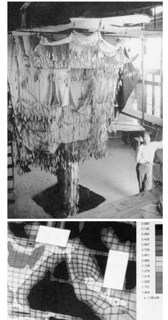
FIGURA 7 | Arriba: fotografía del modelo de estudio y cálculo de la Iglesia Sagrada Familia de Antoni Gaudí. Abajo: estudios y cálculos realizados por Cecil Balmond del Victoria & Albert Museum, obra de Daniel Libeskind. Las variaciones de tonos representan los distintos esfuerzos en la estructura.
