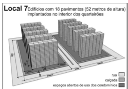
FIGURA 9 | Edifícios com 18 pavimentos implantados no interior dos quarteirões. Fonte: autores.
