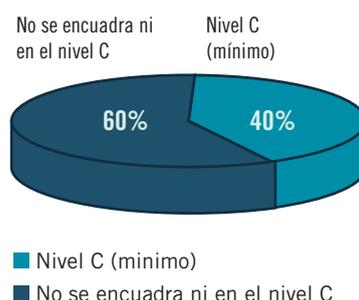
Figura 2 | Resultados de la aplicación de normativa de habitabilidad (IRAM 11605/96) a muros de las UA.
