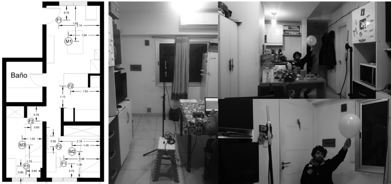
FIGURA 3 | Planimetría de la unidad de estudio con ubicación del instrumental y fuentes sonoras. Fuente: elaboración propia.
