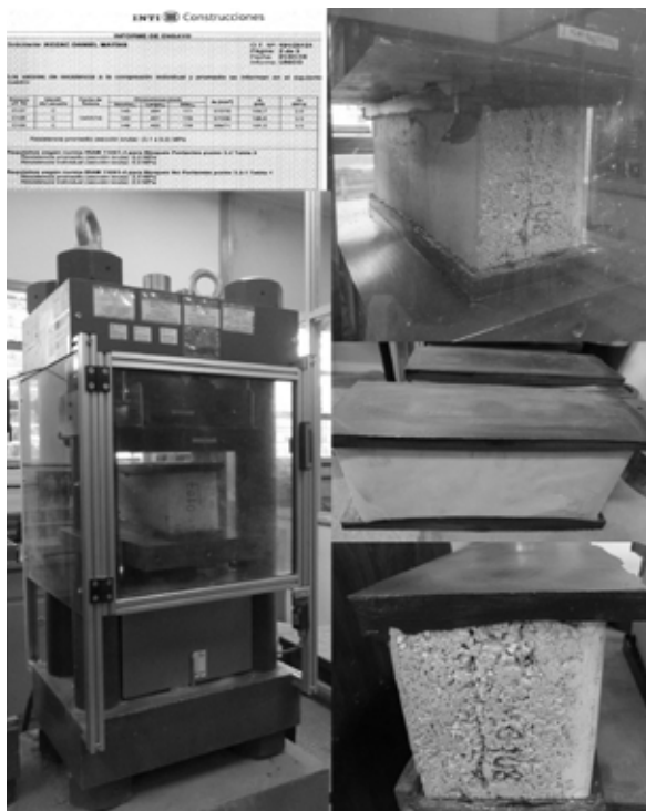
FIGURA 8 | Ensayo de compresión de bloques en INTI. Fuente: Arqs. Caruso y Yajnes.
