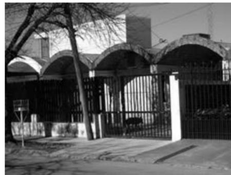
FIGURA 06 | Vivienda en estado original, caracterizada por la cubierta de bóvedas de ladrillos. Fuente: colección del autor.
