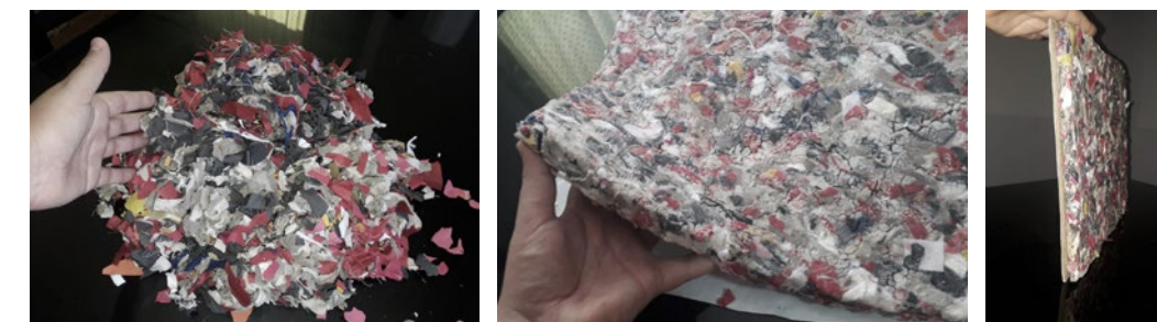
FIGURA 4 | Placa de aislación térmica ejecutada con residuos textiles. Fuente: elaboración propia.
