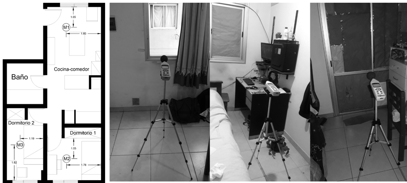
FIGURA 2 | Planimetría general con la ubicación del sonómetro en cada local y relevamiento fotográfico de la medición. Fuente: elaboración propia.
