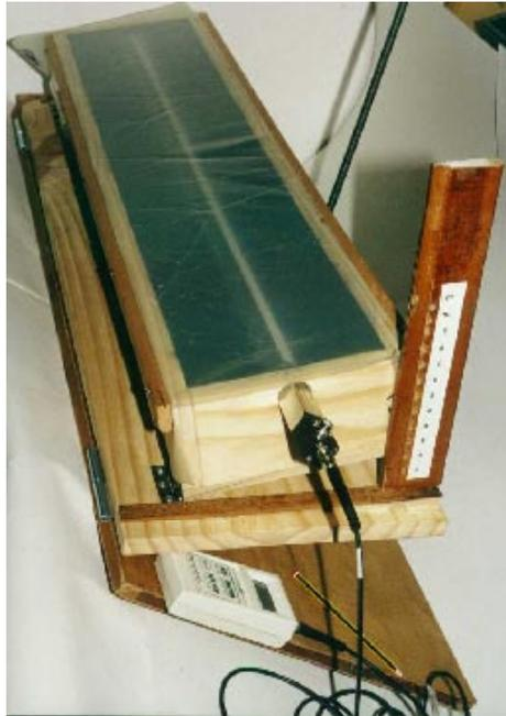
*Fig. 1: Módulo experimental utilizado para la medición de la transmitancia a la radiación fosotintéticamente activa. Puede apreciarse el sensor de medición del flujo visible, la regla graduada y la varilla roscada para obtener los distintos ángulos de incidencia.*
