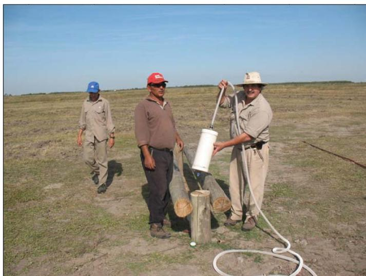
Figura 9. Diseño de chupadores flotantes en perforaciones para los mecanismos de bombeo. Diseño: Lahitte, A.
