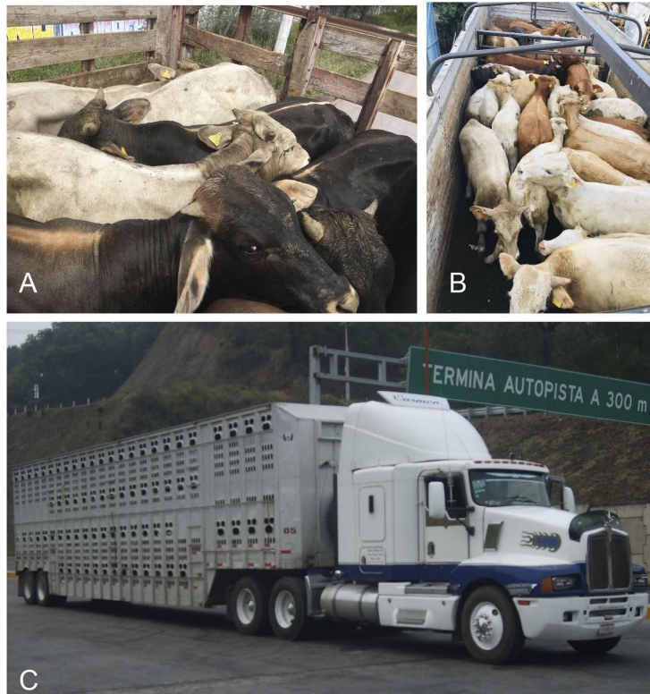
Figura 1. A) Vehículo con redilas para movilizar de 5 a 6 bovinos; B) Camiones de un eje trasero para movilizar de 25 a 30 bovinos; C) Tractor con jaula ganadera para movilizar mayor número de bovinos. Fuente: datos propios con la colaboración de los transportistas que contribuyeron al presente estudio.
