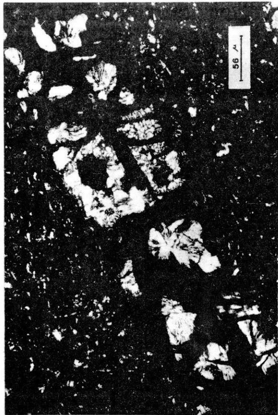
FIGURA 3. Magnificación de la litorrelquia de la foto anterior, con nicoles cruzados. Obsérvese la gibbsita con textura radiada y alotriomórfica suturada. Aumento 6,3 X.
