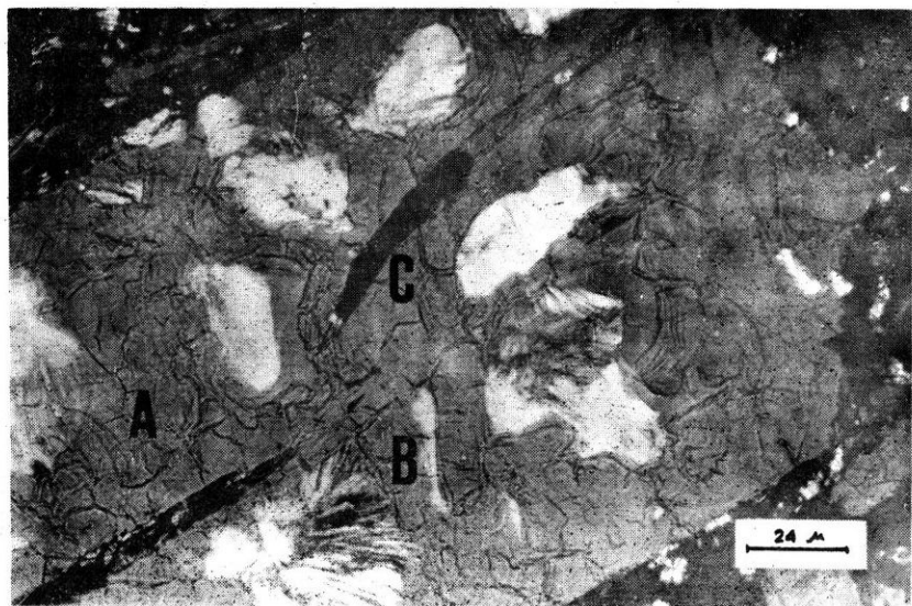
Figura 4. Sector superior derecho de la gran matriz plagioclásica de las fotografías anteriores. Obsérvese el gel aluminosilíceico (A) transformándose paulatinamente en gibbsita (B). Nótese la deposición de material férrico (C). Nícoles semicruzados, aumento 16 X.
