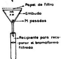
Fig 27 Modo de recuperar fracción pesada y bromoformo
