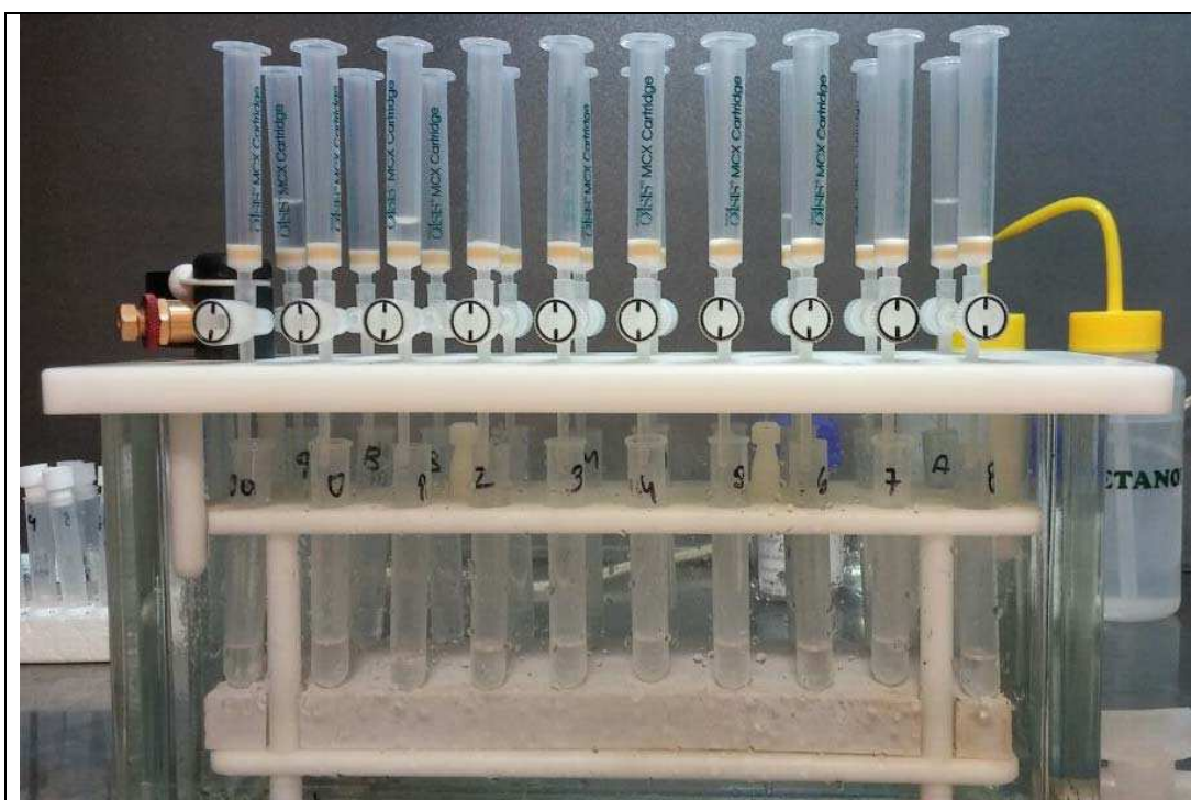
Ilustración 4-C: Imagen del colector de vacío (Manifold VARIAN) utilizado para el proceso de extracción en fase sólida.
