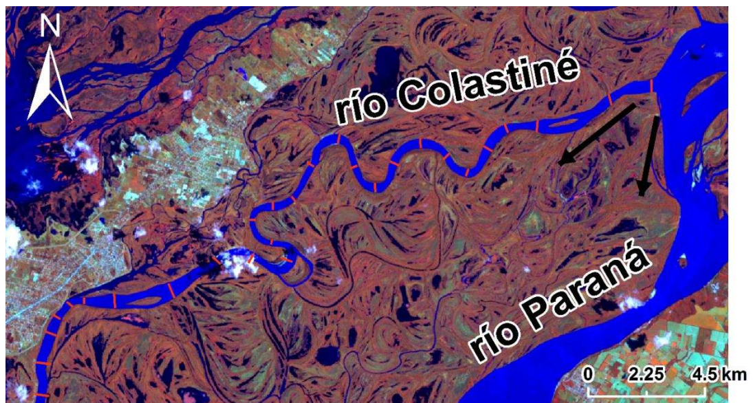
Figura 2.3.- Tramo y secciones de aforo tomadas en la campaña 2011 (C2011).
