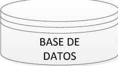
BASE DE DATOS              | Representa una base de datos y se utiliza para la introducción o registro de datos en una base de datos (habitualmente informático).                                                                           |
