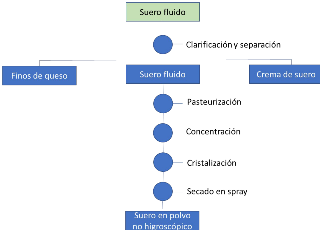
Figura 6.11: Esquema del proceso de elaboración de suero en polvo no higroscópico (modificado de Page et al., 2014).
