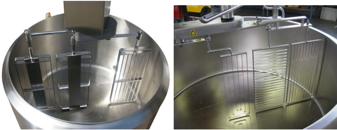
Figura 5.7: Distintos sistemas para cortar el coágulo mecánicamente.
