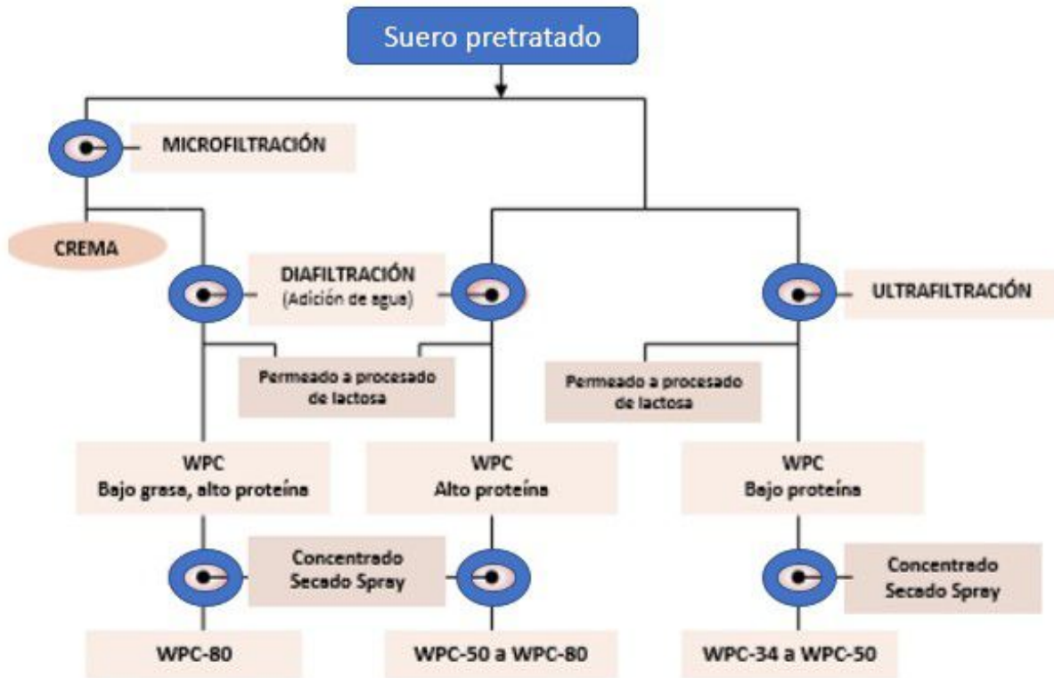
Figura 6.14: Diagrama del proceso de obtención de WPC (modificado de Parzanese, 2017)
