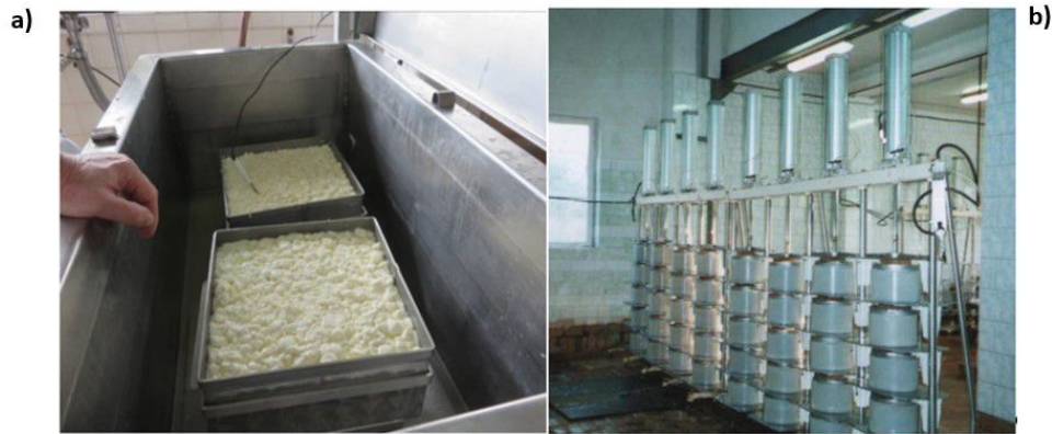
Figura 5.13a: Quesos blandos: leve prensado de la masa por apilamiento de dos (o tres) moldes superposición de moldes. b- Quesos duros o semiduros: prensado intenso mediante el empleo de prensa.
