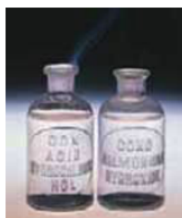
▲ Figura 16.3 El HCl(g) que escapa del ácido clorhídrico concentrado y el NH_3(g) que escapa del amoníaco acuoso (aquí rotulado como hidróxido de amonio) se combinan para formar una niebla blanca de NH_4Cl(s) .
