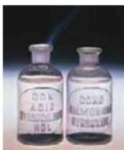
▲ Figura 16.3 El HCl(g) que escapa del ácido clorhídrico concentrado y el NH_3(g) que escapa del amoniaco acuoso (aquí rotulado como hidróxido de amonio) se combinan para formar una niebla blanca de NH_4Cl(s) .
