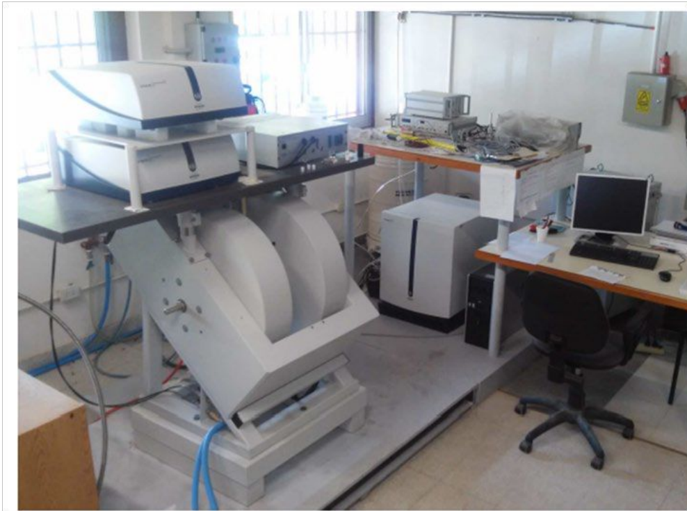
Foto VI.2.1. Espectrómetro de EPR marca Bruker del Departamento de Física de la FBCB, UNL.
