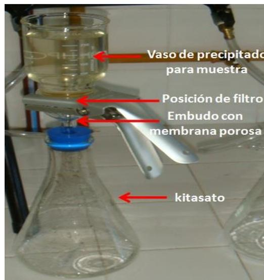
**Figura 2.** Detalle equipo de filtrado (FICH - UNL).
