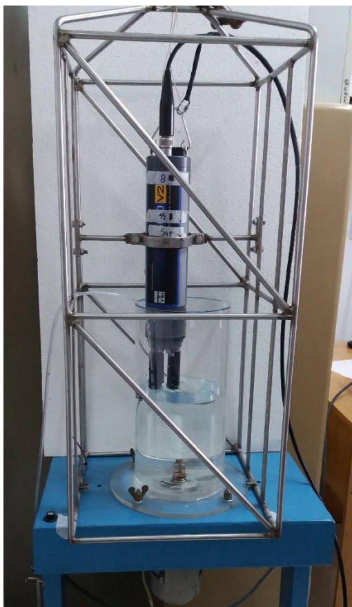
Figura 1- Reactor de mezcla completa y sonda YSI
