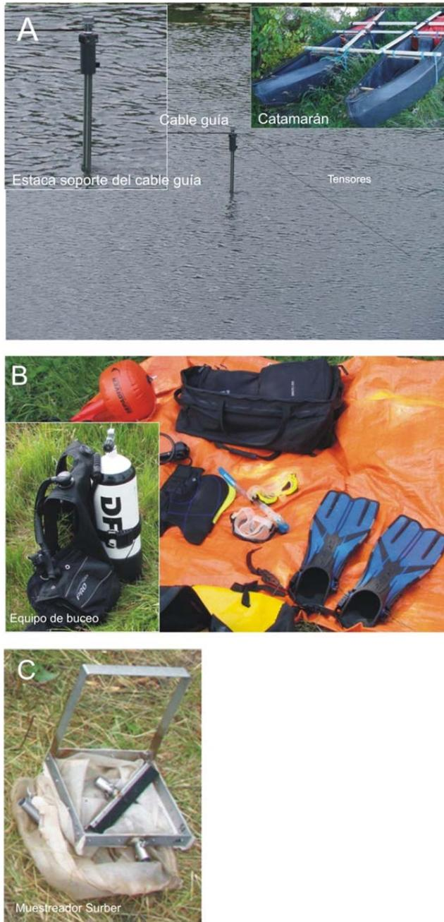
Figura 7. Detalles del procedimiento y materiales usados sobre micro-formas de fondo. A: sitio del emplazamiento del cable guía sobre la forma de fondo, estacas subacuáticas, tensores y embarcación usada (tipo catamarán). B: equipo de buceo empleado para el emplazamiento mencionado y durante el muestreo bentónico. C: muestreador Surber.
