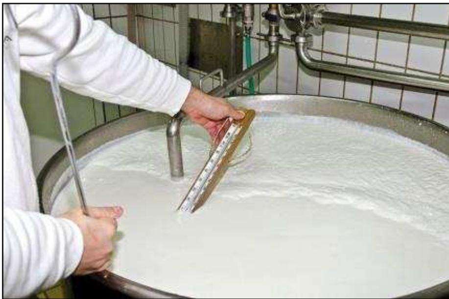
**Figura 17:** Pasteurización en tina, donde se puede apreciar el inconveniente de la formación de espuma producida por las proteínas del suero.
