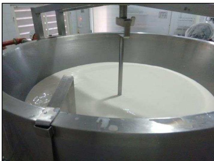
**Figura 24:** Mezclado y homogeneización de leche cruda.
