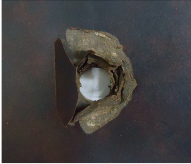
Figura 2.5.2. Test de impacto en un laminado decorativo modificado con 20 % m/m de lignina.
