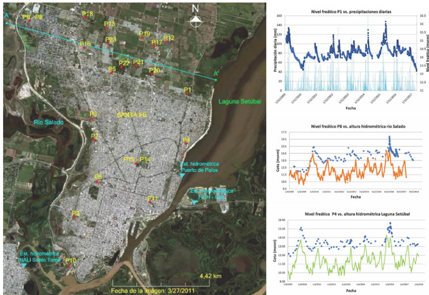
Figura 4.9.1. Ubicación de los pozos de monitoreo y variaciones de niveles freáticos en relación con las precipitaciones y alturas hidrométricas.
