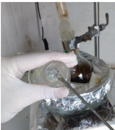
Fig. 13. Síntesis de lactido: extracción mecánica de los cristales en forma de aguja.
