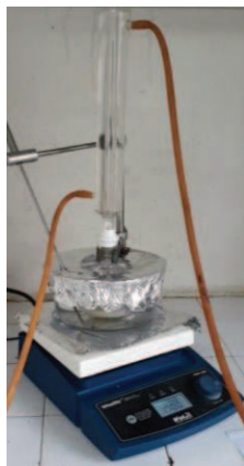
Fig. 14. Sistema de reacción para la síntesis de PLA por apertura de anillo del dímero lactido.
