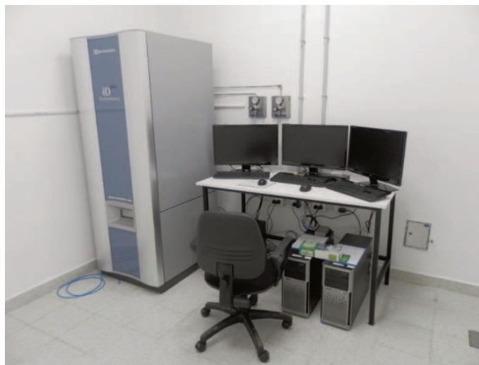
Fig. 10. Equipo SHIMADZU iD plus PERFORMANCE de espectrometría de masas MALDI-TOF.
