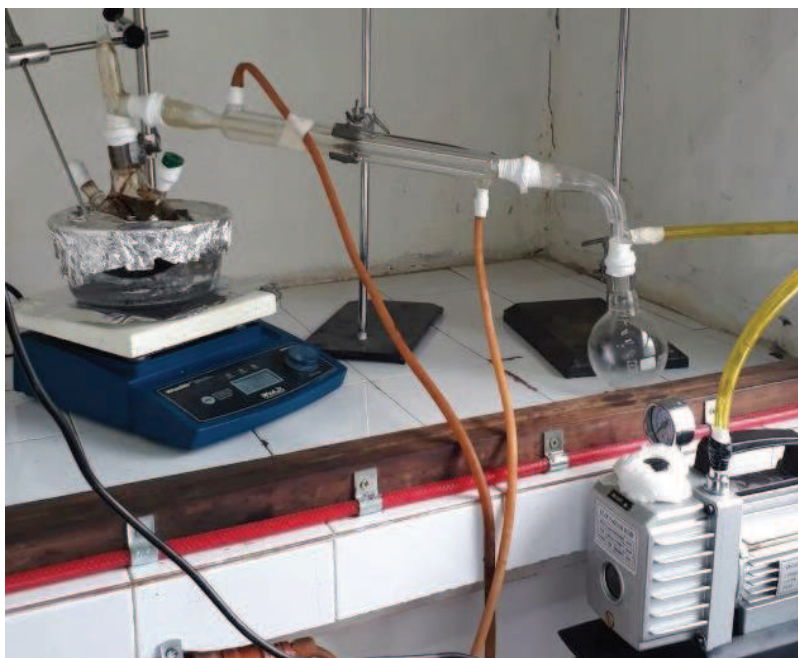
Fig. 12. Sistema de reacción empleado para la oligomerización/depimerización bajo vacío.
