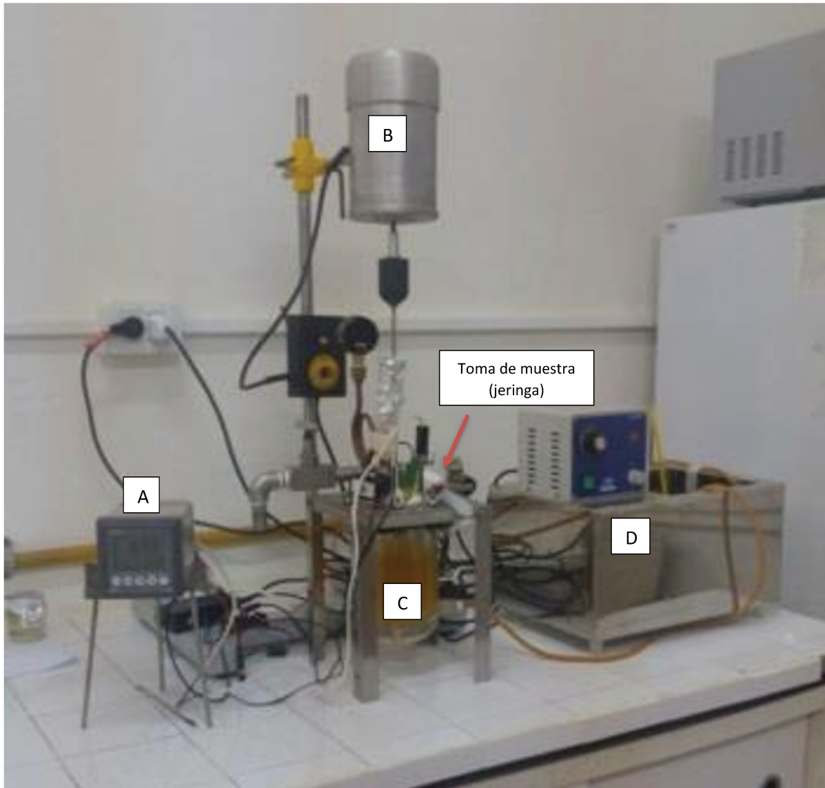
Fig. 11. Sistema de fermentación (A: controlador de pH, B: agitador mecánico, C: fermentador, y D: baño termostatzado).
