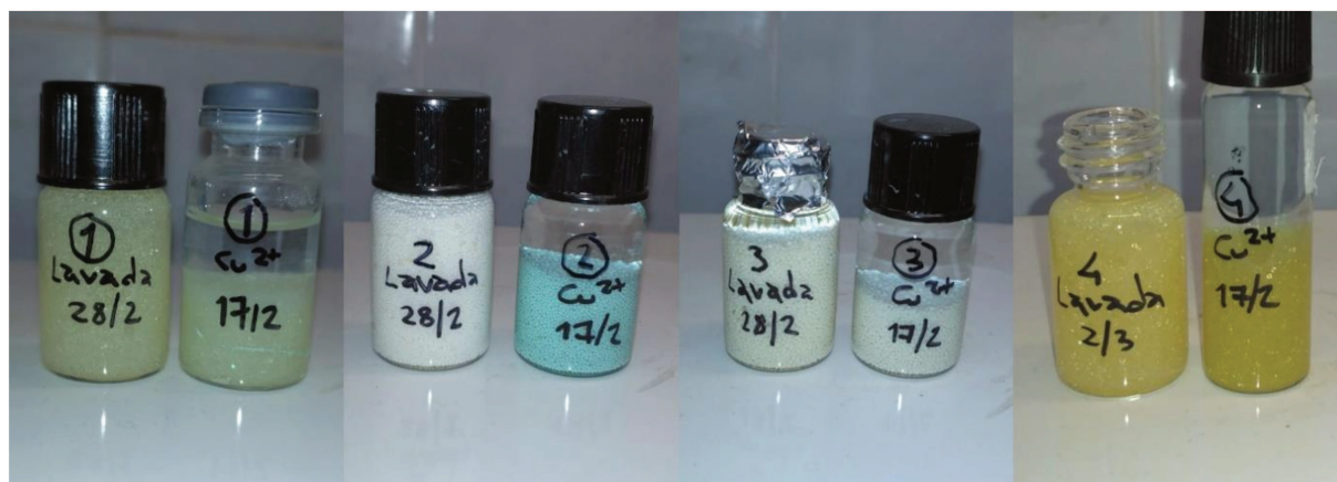
Figura 1: Soportes antes y después (izquierda y derecha en cada cuadro, respectivamente) de la carga de cobre(II).
