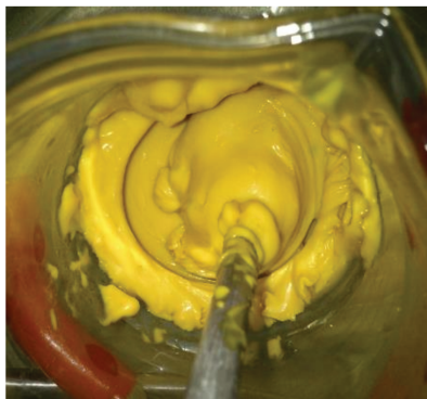
Foto 4.2. Mezcla de reacción de una goma con 0,2 %p/p de una solución de enzimas PLC/PLA2 con agitación mecánica a 55 °C por 90 min.
