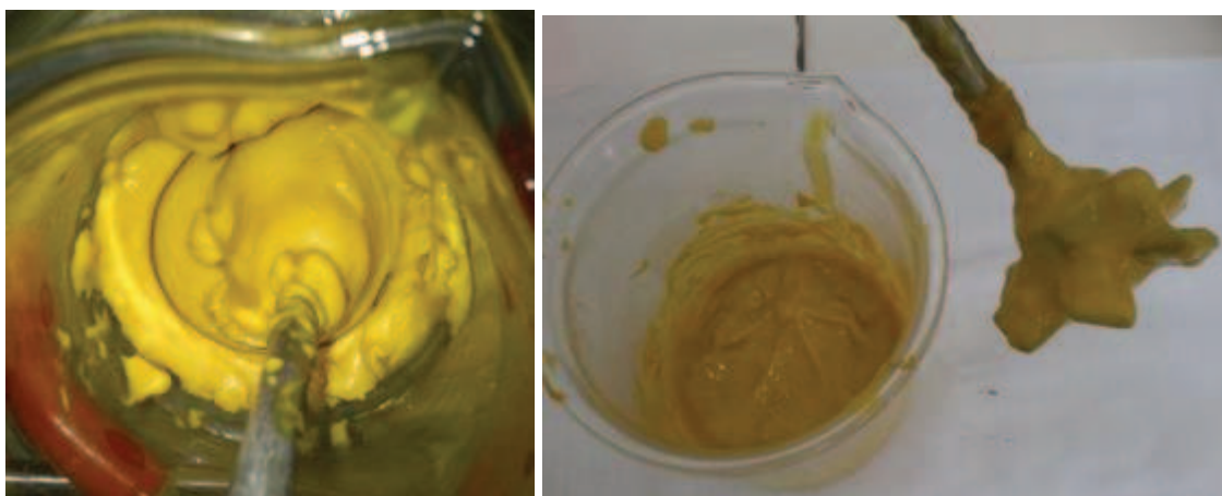
Foto 3.1: Foto del reactor de vidrio y las paletas del agitador cuando se puso a reaccionar el residuo del desgomado con las enzimas a 55 °C.
