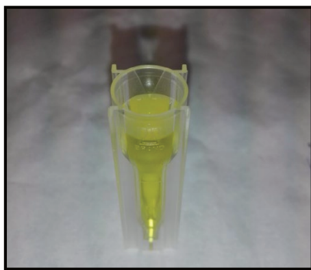
Figura 15. Cubeta de espectrofotómetro. Producto generado como resultado de la reacción del ácido acético obtenido por desdoblamiento de acetiltiocolina con el cromógeno ácido 5,5-ditiobis-2-nitrobenzoico.
