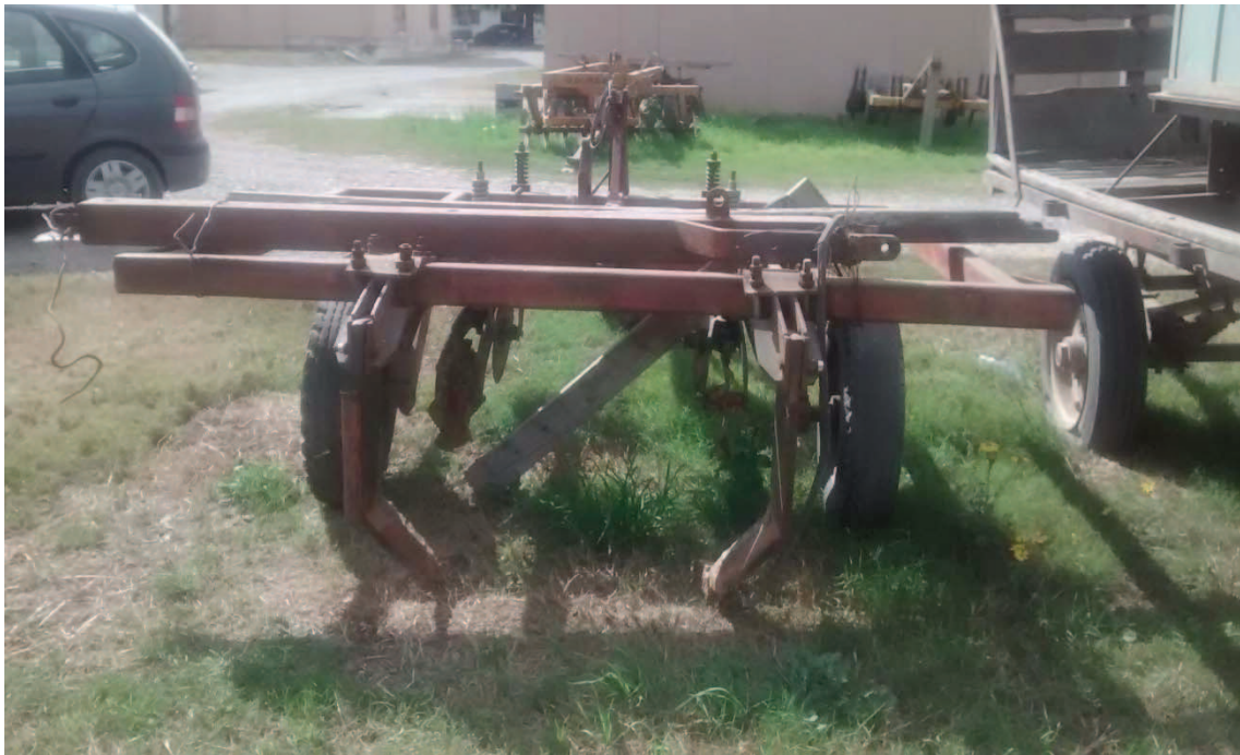
Figura 5.4. Subsolador profundo de arrastre con dos brazos angulados.
