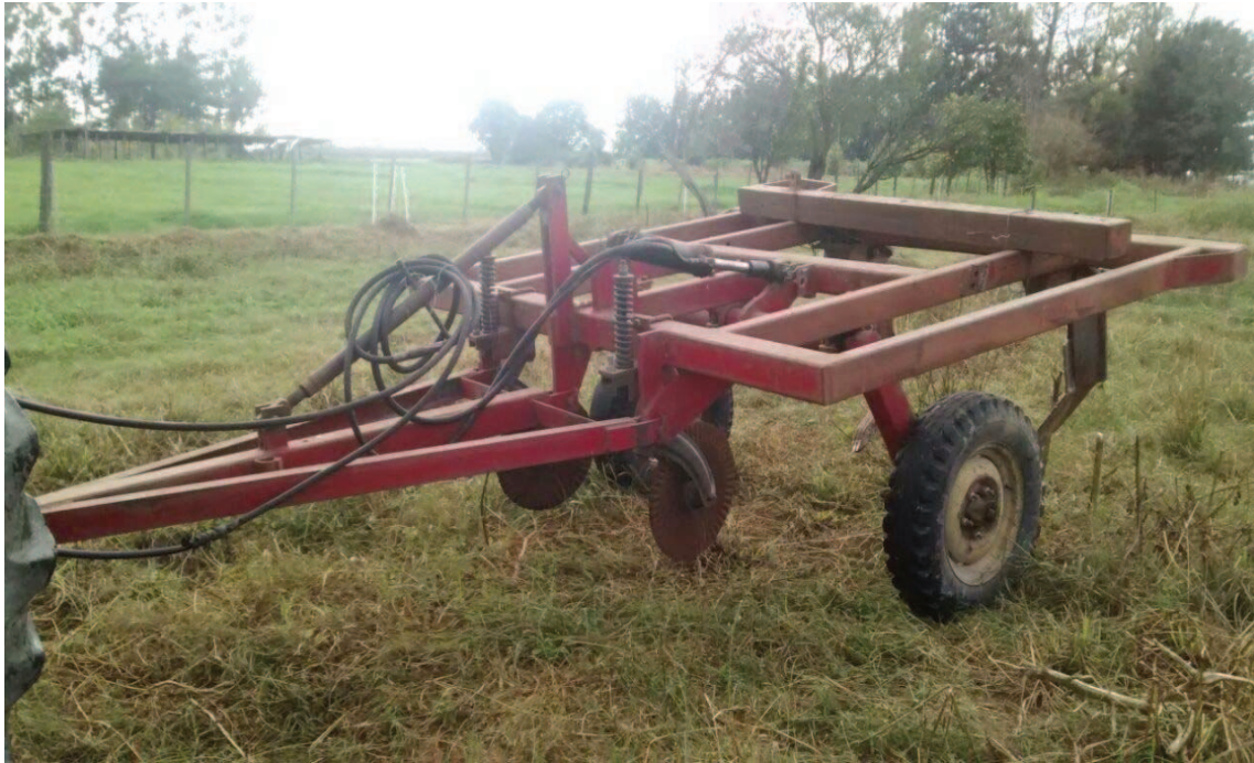
Figura 5.3. Detalle del subsolador profundo de arrastre.
