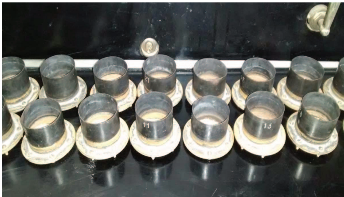
Figura 3.6. Microtamices utilizados para la determinación de la estabilidad de los agregados del suelo.
