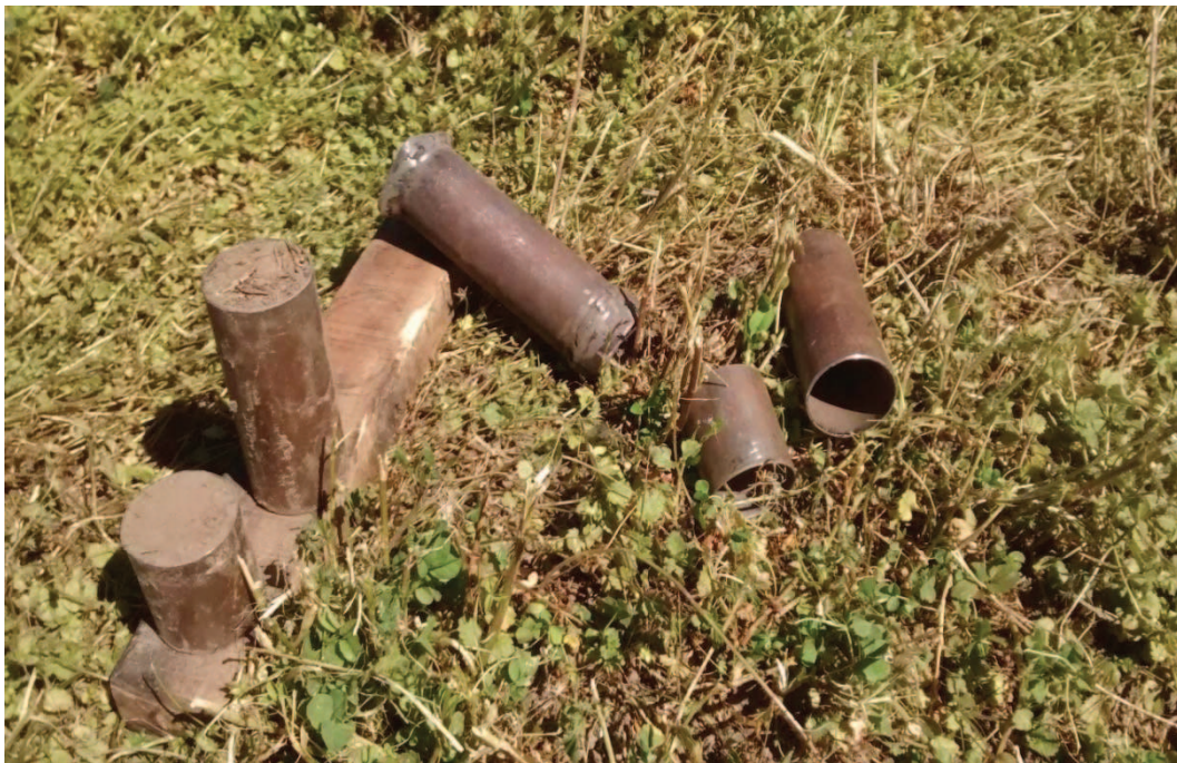
Figura 3.5: Cilindros para la determinación de densidad aparente del suelo.
