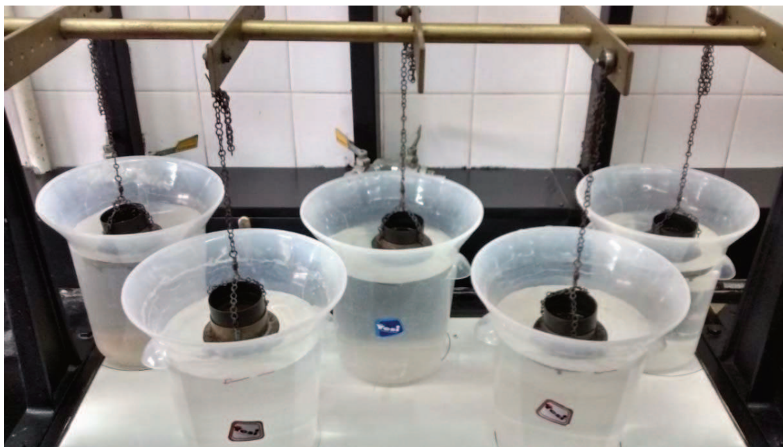
Figura 3.7. Tamizado en húmedo usando microtamices, con movimientos oscilatorios durante la determinación de la estabilidad de los agregados del suelo.
