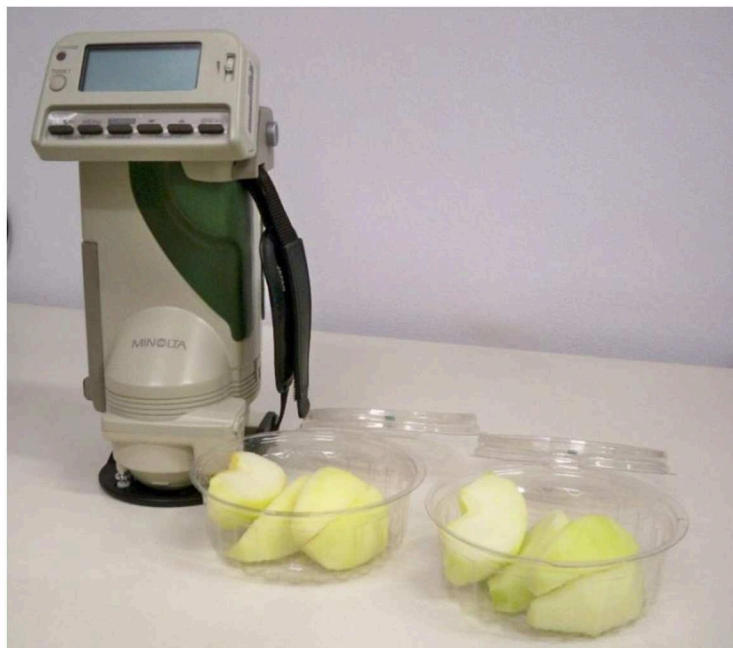
Figura 2.9. Espectrofotómetro utilizado para la medición del color.
