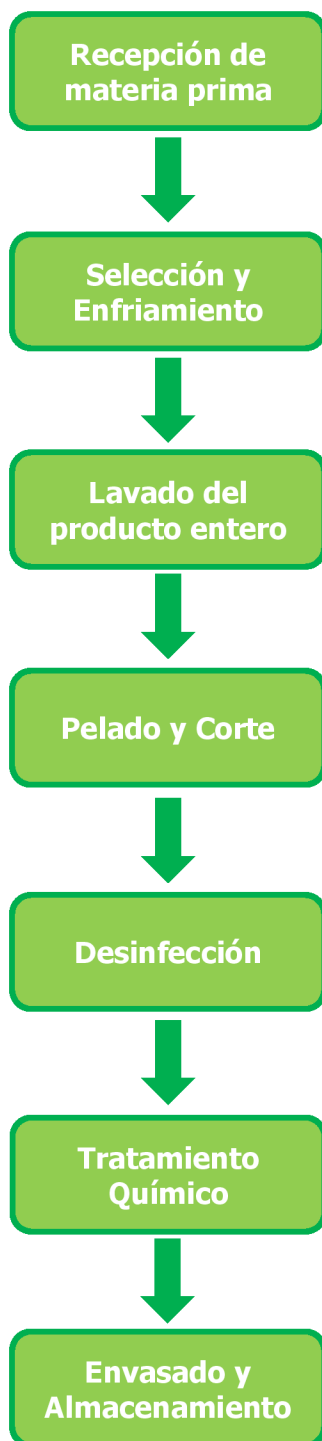
Figura 1.5. Diagrama de flujo del procesamiento mínimo de manzanas.
