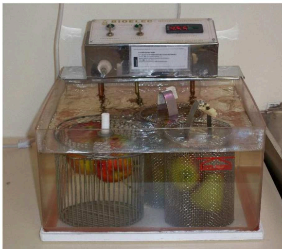
Figura 2.5. Baño de agua termostatzado y con agitación.
