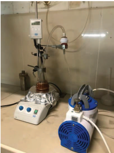
Figura 1. Esquema del equipo utilizado para la generación de microgotas.
