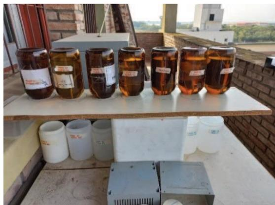
**Figura 1:** Sistema de colección de biogás, donde el biogás es acumulado, el líquido genera un sello hidráulico y cae venciendo la tensión superficial.
