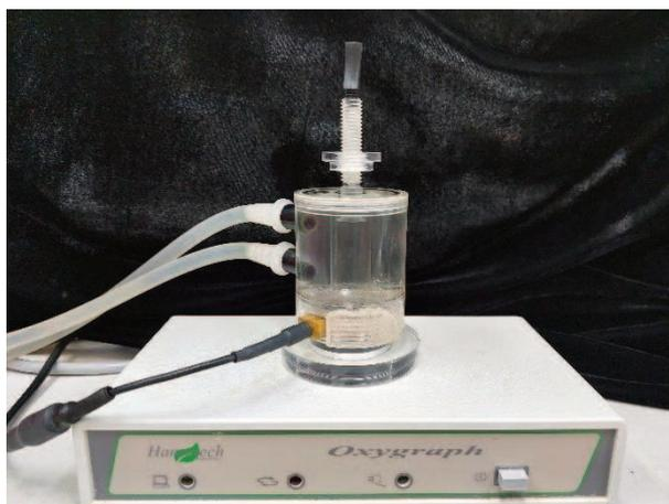
**Figura 40.** Electrodo de oxígeno del tipo Clark (Hansatech, Norfolk, UK).
