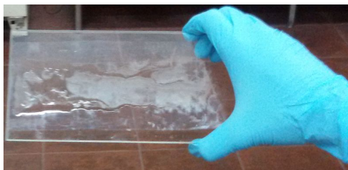
Figura 4.10. Imagen de la película C_0MR_{60/40} , ilustrando la mala capacidad del látex para formar película sin formulación.
