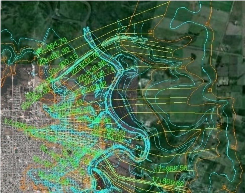
Figura A11.1: Perfiles del modelo entre el arroyo Gualeyán y el Puente de la Balsa
