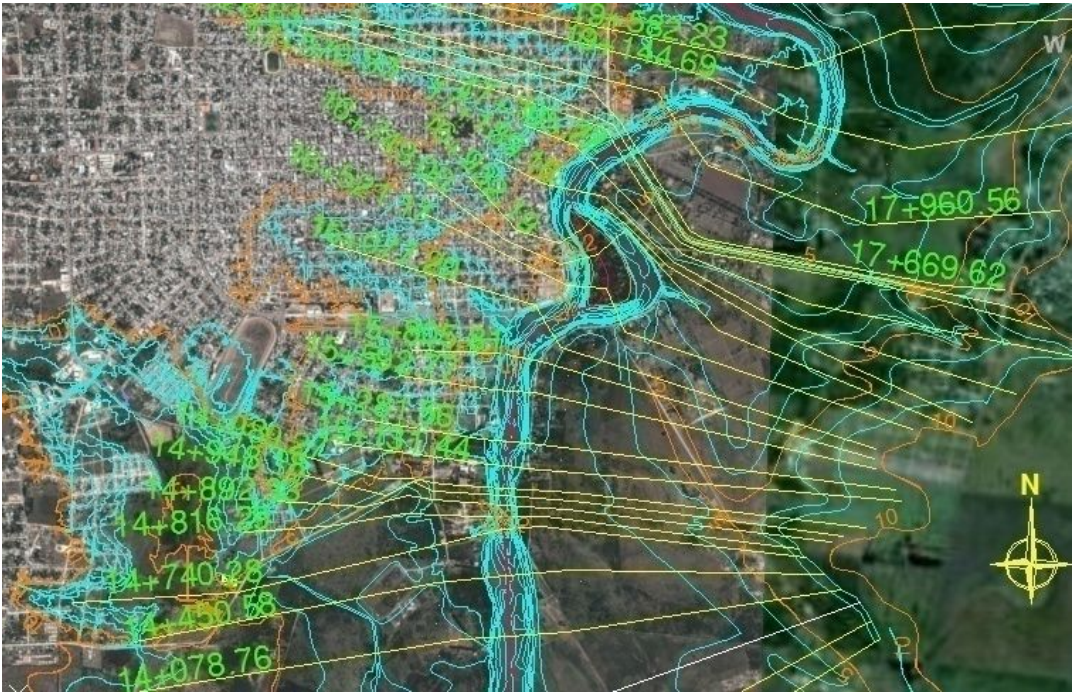
Figura A11.2: Perfiles del modelo entre el Pte. de la Balsa y la zona sur de Gualeguaychú
