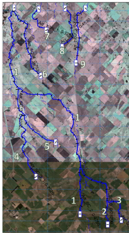
Figura 5.3 – Topología implementada en el MIKE 11 para la modelación hidrodinámica de la red de drenaje
