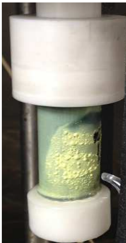
Figura 3.3. Fotografía del electrodo cilíndrico rotatorio de acero inoxidable 316 L recubierto de azufre luego de una electrólisis.
