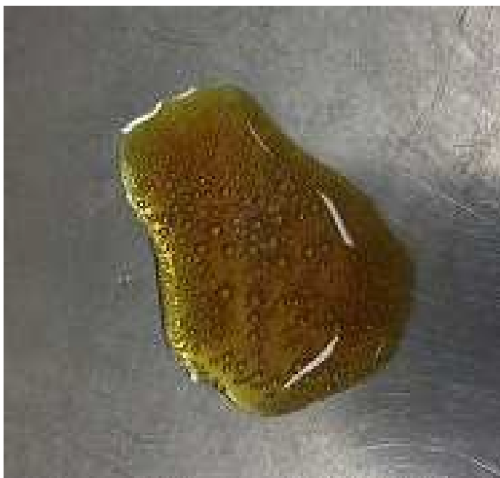
Figura 3.5. Fotografía del resultado del ensayo a la gota para la detección de sulfuros.
