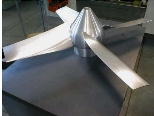
Figura I-5: Hélice del prototipo de la turbina hidrocínética diseñada por el INVAP [14].
