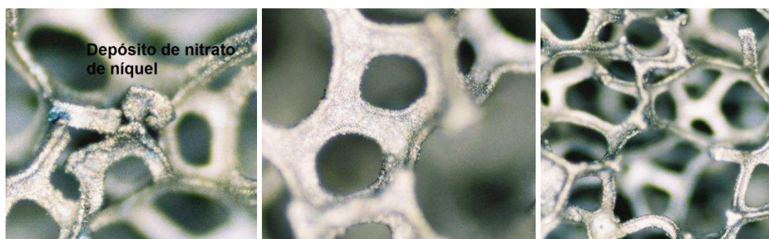
Figura 2. 1 Micrografía (100X) de esponja de Ni Celmet decapadas con ácido nítrico 0,1 M.
