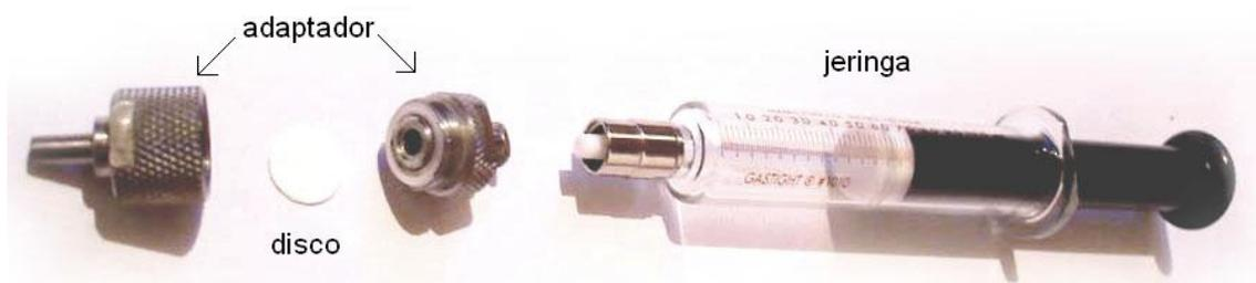
El uso de discos evita algunos inconvenientes asociados al proceso de extracción líquido-líquido, como la formación de emulsiones, el trabajo laborioso, el costoso material de vidrio y el uso de excesiva cantidad de solvente.
