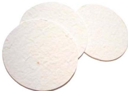
Las micropartículas de PTFE no interfieren con la actividad del sorbente, dejando libre su superficie para la interacción con la muestra durante la separación. La matriz de PTFE es compatible con todos los solventes orgánicos e inorgánicos y, por ser inerte, confiere una alta pureza a la extracción (Varian Analytical Instruments, 2001-2002).
