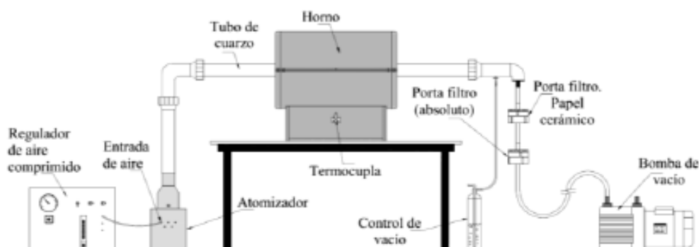
Figura 2. Esquema del equipo de impregnación por Spray (MOST, UCL, Bélgica).
